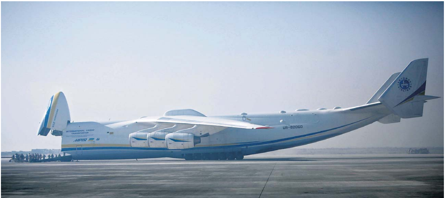
Klappe auf: Die Antonov An-225 bietet nicht nur so viel Frachtraum wie kein anderes Flugzeug, sie lässt sich dank der aufklappbaren Bugnase auch effektiv beladen.
